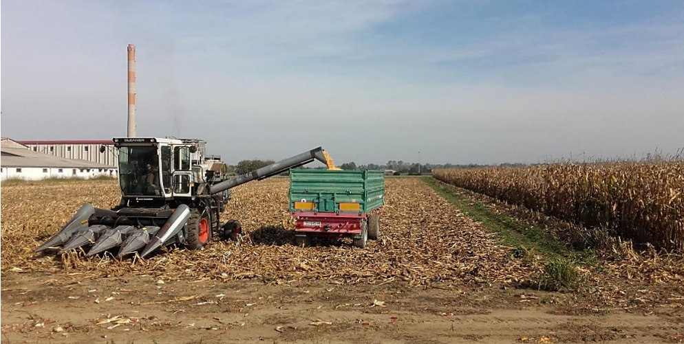
Slika 61. Žetva četverorednim kombajnom, pražnjenje koša u prikolicu.
