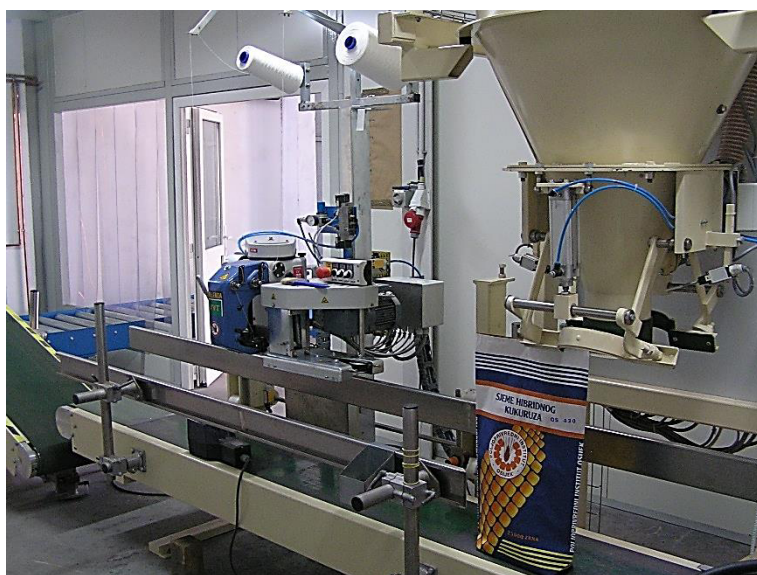
Slika 11.15. Poluautomatska linija za pakiranje vreća sjemena (vaga i šivaljka) u pogonu dorade sjemena u Poljoprivrednom institutu Osijek
