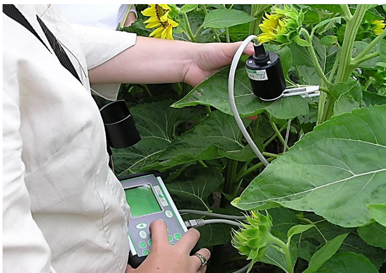
Slika 5.5. Mjerenje parametara fotosinteze
