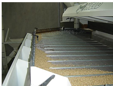
Slika 11.13. Gravitacijski stol u pogonu dorade sjemena u Poljoprivrednom institutu Osijek
