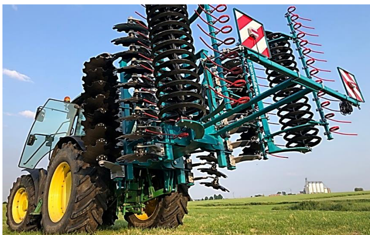
Slika 6.4. Kombinirano oruđe koje u sebi ima elemente sjetvospremača
