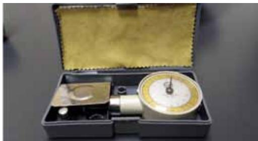
Slika 2. Penetrometar sa pripadajućim nožićem
